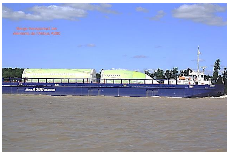
Transport sur barge des éléments de l'Airbus A380 (Cliché Ph. Fournet)
